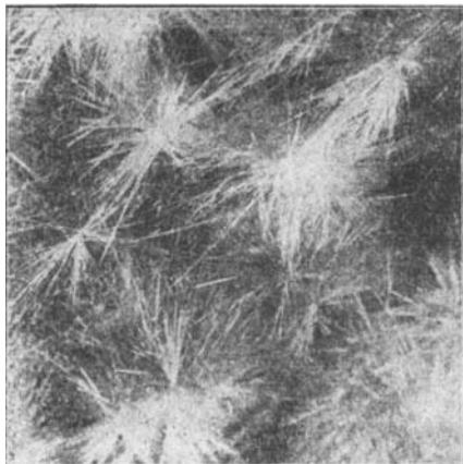
Unter dem Mikroskop bestanden die langen prismatischen Nadeln aus aggregierten Fäden, die dem rhombischen oder monoklinen System angehören (anisotrop, gerade Auslöschung). Die Mutterlauge lieferte nach teilweisem weiteren Eindunsten eine zweite Krystallisation. Die Ausbeute an reinem Ormosin beträgt 0.15 %, bezogen auf trocknes Samenmaterial.
